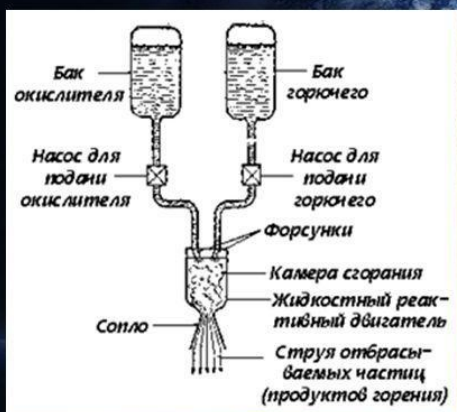
Простейшая схема жидкостного реактивного двигателя
